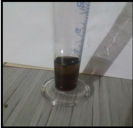
الشكل (3-15): محلول الغروي للجسيمات (Au-Cu) النانوية المترابكة المحضرة اثناء عملية الاستئصال بالليزر (بعد الخلط).
